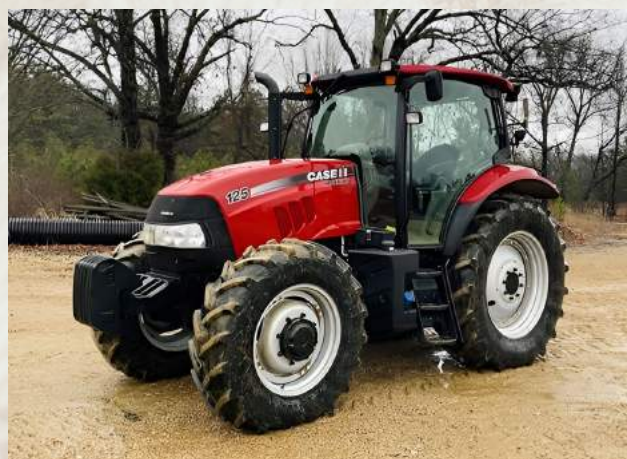
CASE MAXXUM 125 Potência: 125hp Motor: 6 cilindros/turbocharged and intercooled Transmissão: 4WD
