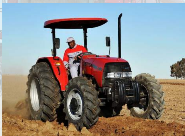
CASE Straddle JX 80 / Straddle JX 95 Potência: 80hp / 98hp Motor: 4 cilindros / 4 cilindros Transmissão: 4WD
