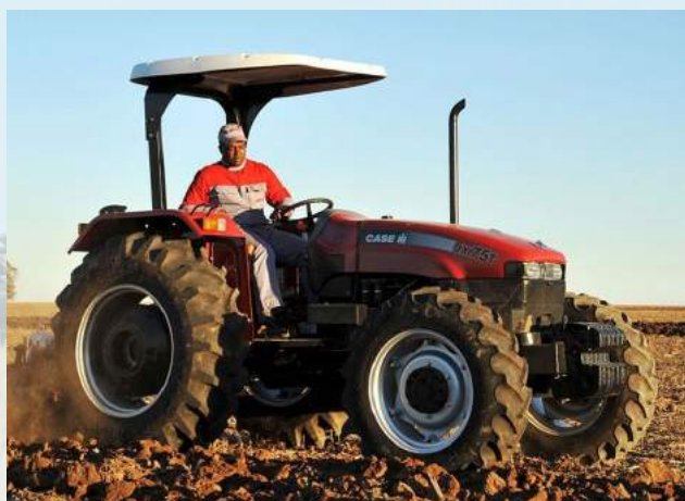
CASE JXT 55 / JXT 75 Potência: 55hp / 75hp Motor: 3 cilindros / 4 Cilindros Transmissão: 4WD / 4WD
