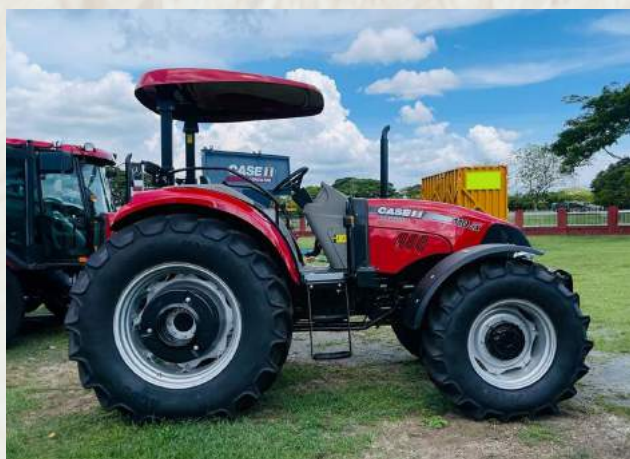
CASE Farmall JX 110 Potência: 110hp Motor: 4 cilindros Transmissão: 4WD
