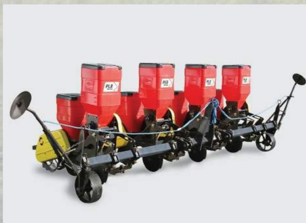
Semeador de 4 linhas PLB-04 Largura do cabeçalho (mm): 2800 | 3300 | 3800 | 4400 Largura útil (mm): 2400 | 2900 | 3400 | 4000 Largura total: 3300 | 3800 | 4300 | 4900 Peso aproximado (kg): 766 | 777 | 787 | 841 Potência do trator (hp): 60-75
